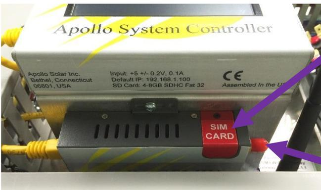
Le Gateway GSM+WiFi est situé sous l'ASC. La carte SIM pour modem GSM est située juste à l'intérieur de la porte rouge avec un accès facile à la face avant du système.
